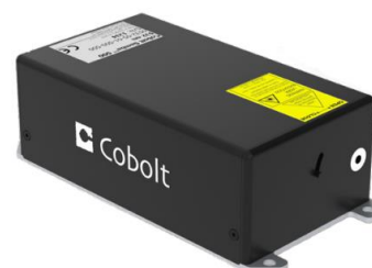
Cobolt 05-iE 全集成版本，无需外部控制器 (134x70x45mm)
