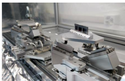
瑞士光源大分子晶体学的高精度透镜对 准@PSI
