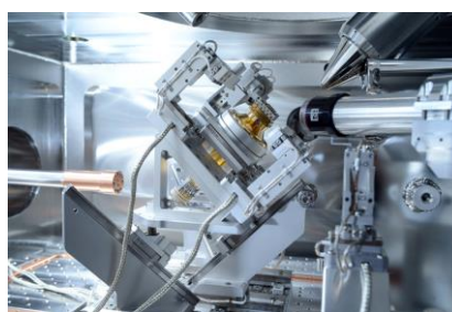
同步加速器端站的多轴定位和探测系统 @NSRRC
